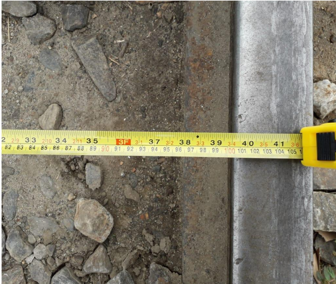
Figura 5: Medidas do comprimento da via férrea de bitola métrica na cidade de Três Rios (RJ), localizada na região Centro-sul fluminense.
