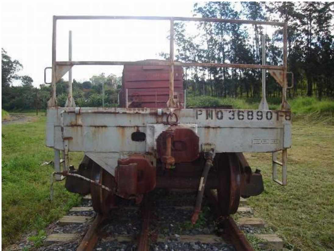
Figura 6: Vagão madrinha de engates fixos. Fonte: Google Imagens (2019).
