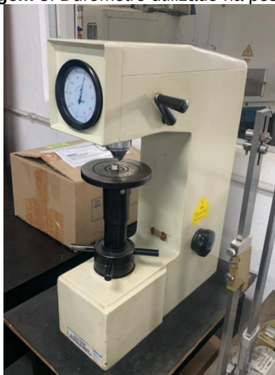
Imagem 3: Durômetro utilizado na pesquisa.
