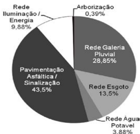
Figura 1: Gráfico Del-Pra Fonte: Manual de Drenagem Urbana, 2016
