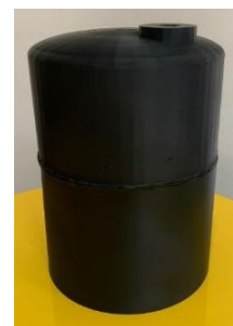
Figura 4. Impressão 3D dos componentes utilizados para a construção do tanque de decantação e biofiltragem.
