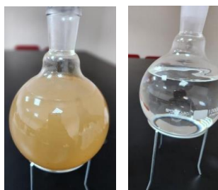
Figura 5. Água de arraste da coleta antes (à esquerda) e depois do processo de decantação e biodespoluição (à direita).
