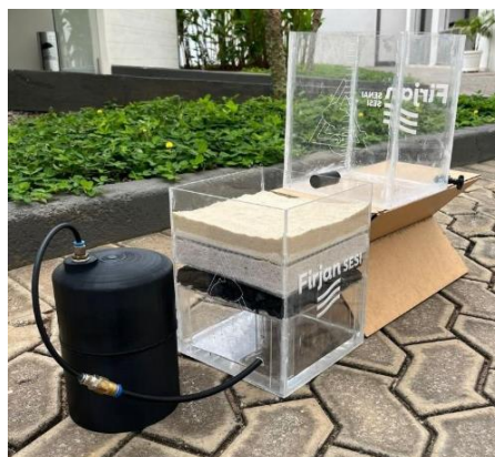
Figura 3. Montagem do tanque de decantação e biofiltração.
