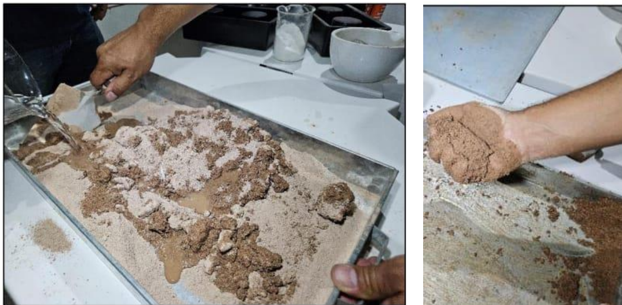
Figura 5 e 6: Mistura manual da argamassa.
