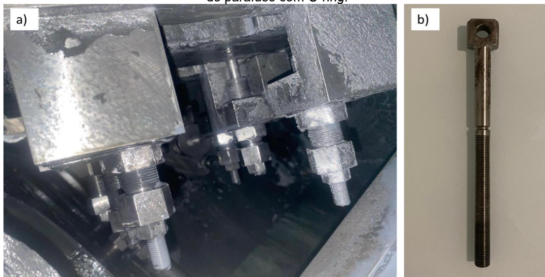
Figura 1 - Posicionamento do parafuso na máquina. a) Conjunto dos seis parafusos; b) Detalhamento do parafuso com O-ring .
