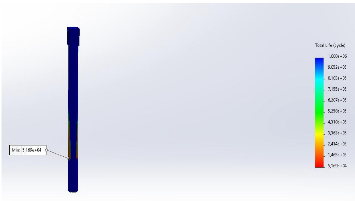
Figura 7 - Resultados do parafuso sem concentrador de tensão.
