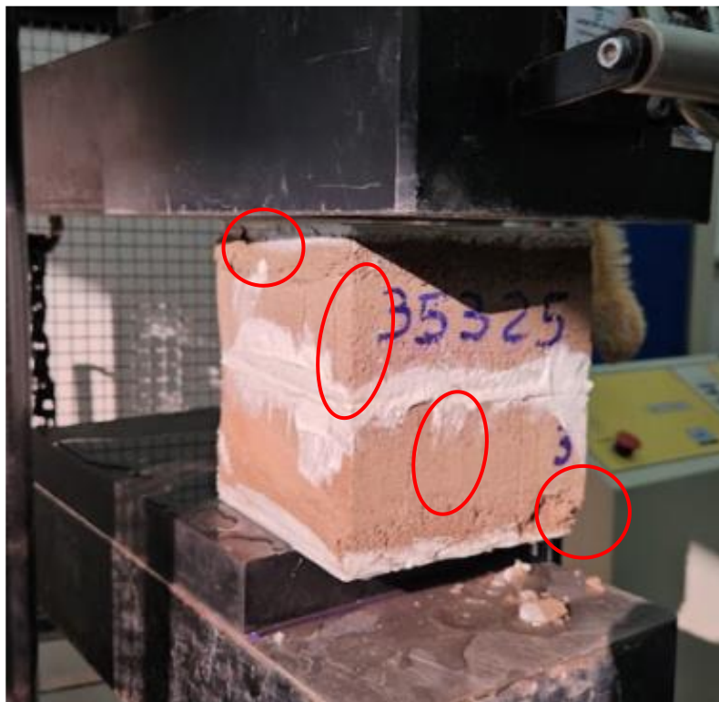
Figura 8: Peça rompida após teste de compressão.
