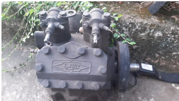
Figura 1 – Compressor alternativo Bitzer com acionamento por polia.
