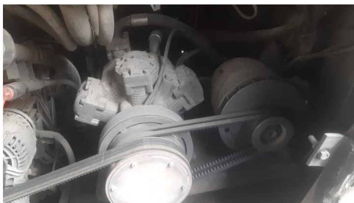
Figura 2 – Compressor de ar e sistema de correias
